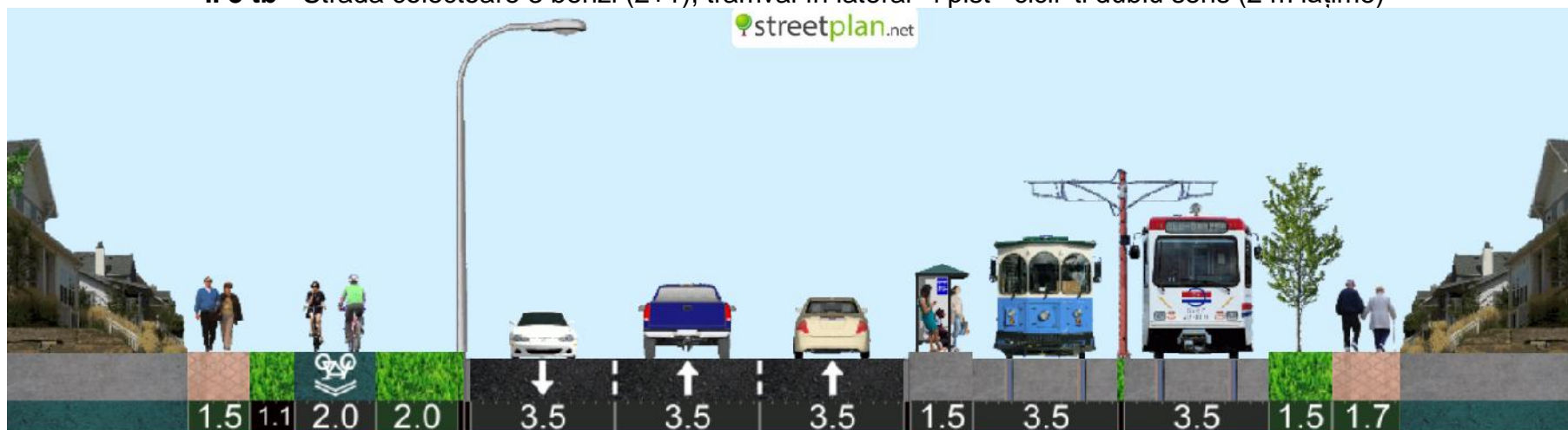
II 3 tb - Strada colectoare 3 benzi (2+1), tramvai în lateral și pistă cicli ti dublu sens (2 m lățime)
