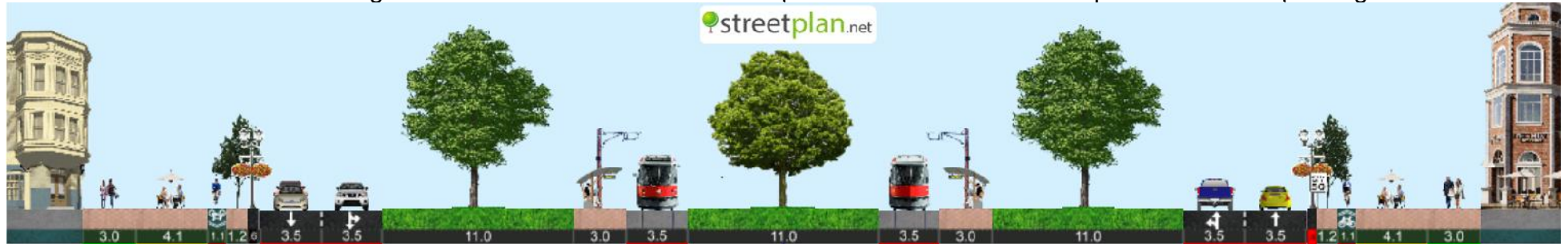
I 4 tb/1 - Arter magistral 4 benzi - Bulevardul Revoluției – sector Primăria Municipiului Arad – Piața Podgoria
