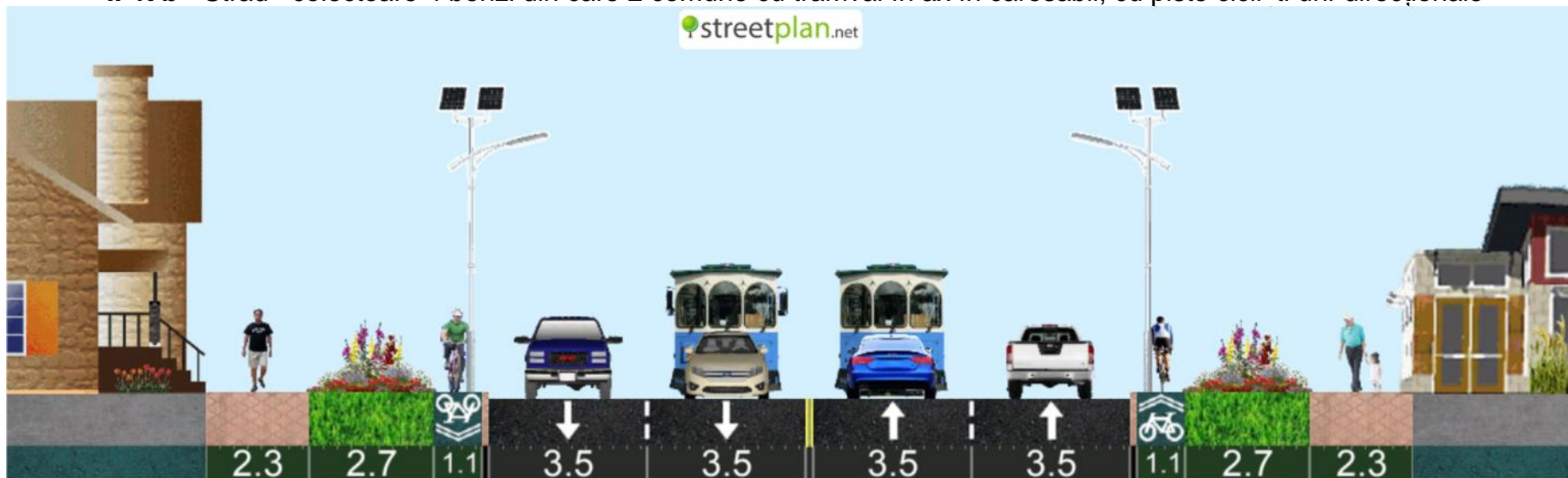
II 4t b - Strada colectoare 4 benzi din care 2 comune cu tramvai în ax în carosabil, cu piste cicli ti uni-direcționale
