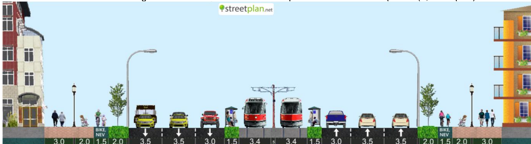
I 6 tb/2 - Arteră magistrală 6 benzi cu tramvai în ax cu piste biciclete uni-direcționale (1,5 m lățime)
