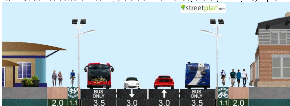
II 4 b/1 - Strada colectoare 4 benzi, piste ciclistice uni-direcționale (1 m lățime) – profil redus
