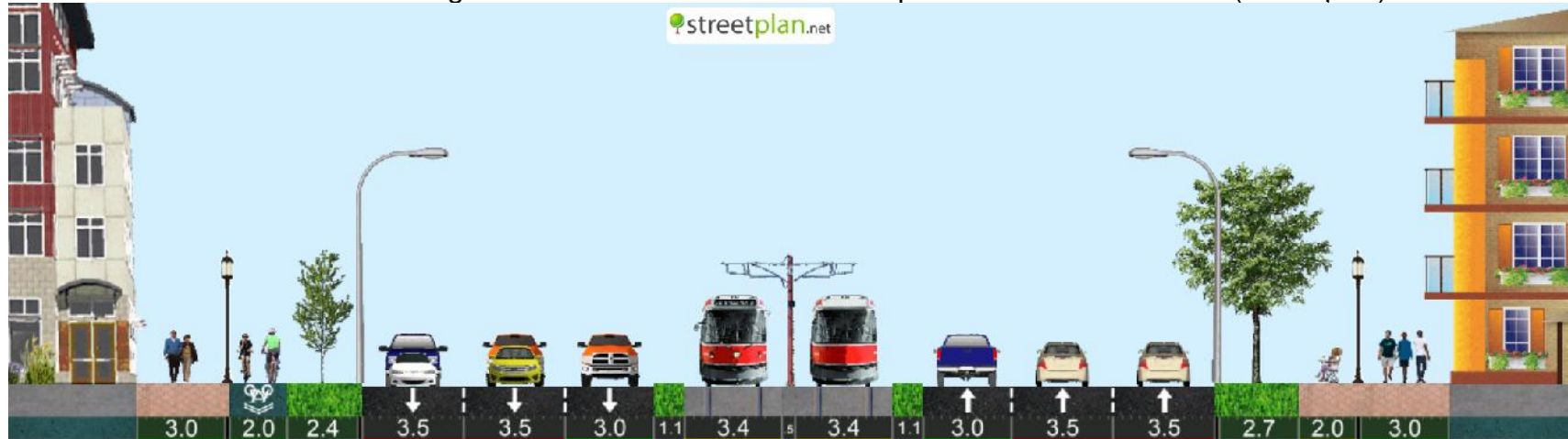
I 6 tb/1 - Arteră magistrală 6 benzi cu tramvai în ax cu piste biciclete dublu sens (2 m lățime)
