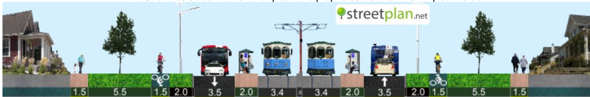
II 2 tb - Strada colectoare 2 benzi cu platforma proprie de tramvai în ax și piste de cicluri
