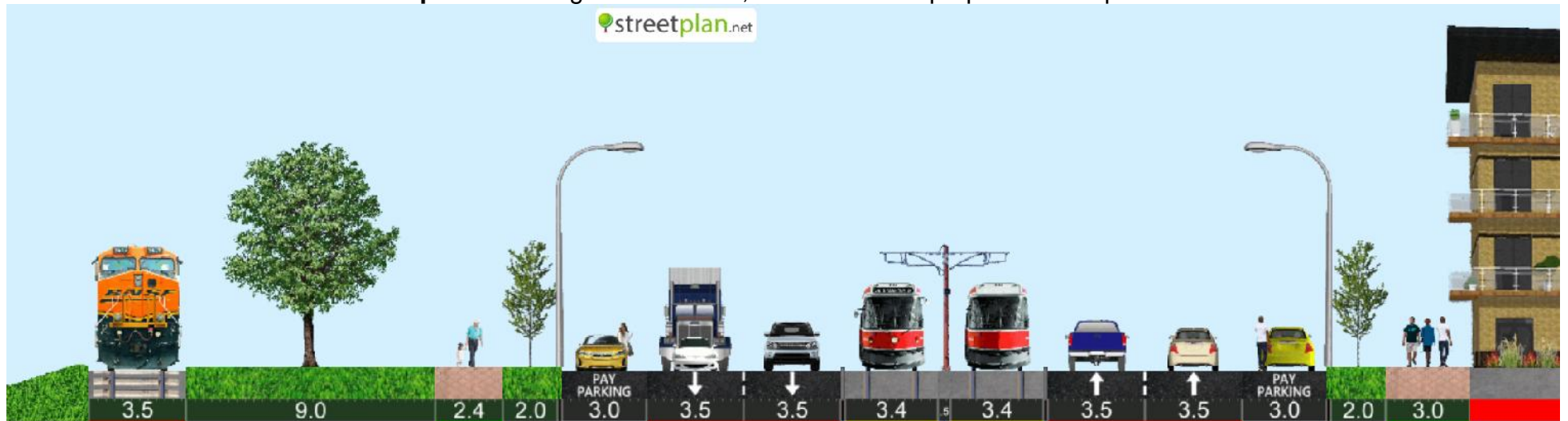
I 4 tp - Arter magistral 4 benzi, tramvai în cale proprie în ax i parcare
