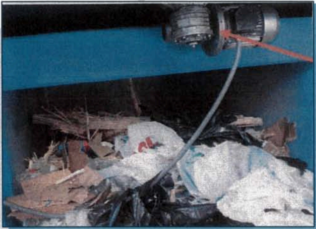
PARTE A MOTOREDUCTORULUI CARE PERMITE MISCAREA PIEPTANULUI
